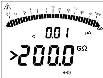
Sollte bei der Isolationsmessung ein Messwert auftreten, der den Messbereich überschreitet (dieser hängt jeweils vom Gerät und der Prüfspannung ab), erfolgt eine Meldung durch das Gerät.
