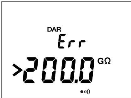
Bei CA 6524 und CA 6526, wenn dieser Fall beim DAR- bzw. PI-Messen auftritt, unterbricht das Gerät die Messung und es erscheint die gegenüber abgebildete Anzeige.
